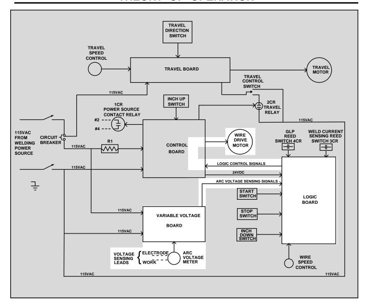
FIGURE E.3 - VARIABLE VOLTAGE BOARD
