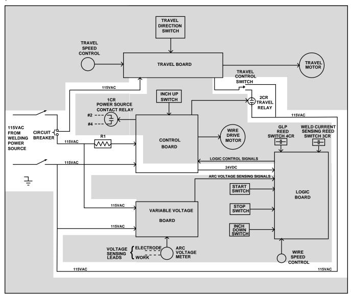
FIGURE E.1 - 115VAC INPUT POWER CIRCUITS
